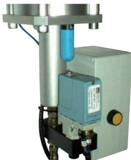
**Unidad OCC independiente con pinza oleo-neumática IP**
