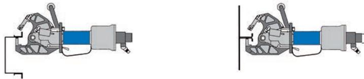
**Máquinas modulares:** con frecuencia es necesario hacer el punto de clinchado muy lejos del borde o pasar por encima de resaltos. Este tipo de máquinas son la mejor solución para estos casos, ya que se pueden entregar varias dimensiones y geometrías de cabezas en "C" que utilizan la misma unidad de fuerza.
