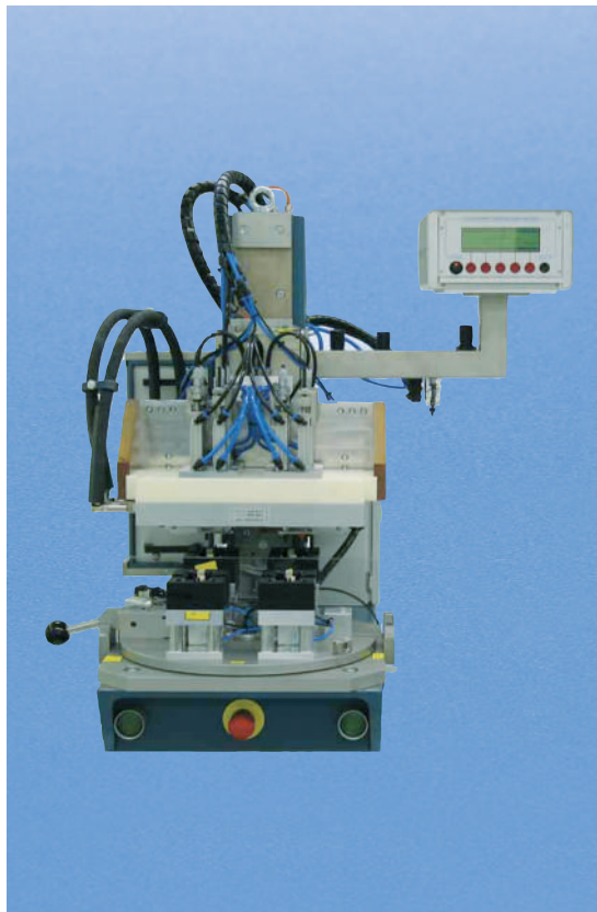
Máquina de colocación por calor (ERW) de ocho insertos de M 1.6 en dos carcasas de un teléfono móvil.
