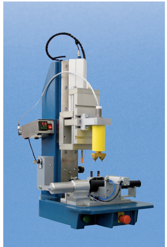
Máquina KVT Basic 2500 para la colocación simultánea por calor de dos insertos en un conducto de aire de automóvil.
